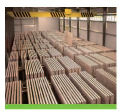
在六條生產線當中,五條為可產出厚度介 乎10至100毫米的水泥木絲板材的標準生 產線。而另一條為大型牆體結構件生產 線,主要生產約3米x6米x40厘米厚,可直 接安裝為牆體的大型牆體結構件。這條生 產線為全球最先進的全自動生產線。
